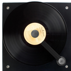
Foto 4: posizione del braccio durante il procedimento di aspirazione
