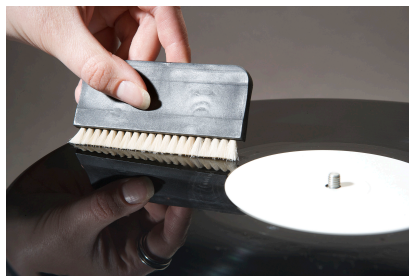
Abbildung 3: Verteilen der Reinigungsflüssigkeit
