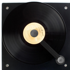
Фото 4: положение всасывающей трубки во время процесса всасывания
