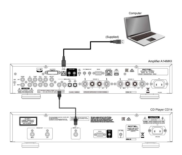
Figure 5: 12V Trigger Connections Branchementstrigger 12 V 12V-Trigger-Anschlüsse Conexiones para Señal de Disparo de 12V De 12V trigger aansluitingen Collegamenti segnali Trigger 12 V 12 V-anslutning för styrsignal Подсоединение 12-В триггерного сигнала
